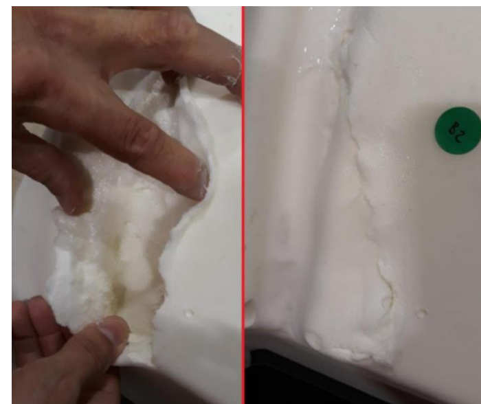
使用粘合剂修复泡沫中的缺陷
